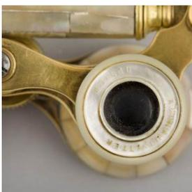
distantes. Está compuesto por dos pequeños telescopios, que pueden enfocar simultáneamente y que son ajustables a través de un tornillo central, además posee una varilla o “lorgnette” que permite sostenerlos.
