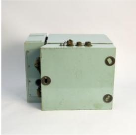
electrónico, que en su parte frontal tiene interruptores y perillas y en su parte posterior, dos cables para conectarlo a la unidad magistral.
